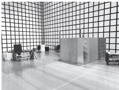
大型電波暗室を用いた歩行者検知レーダ実験の様子
